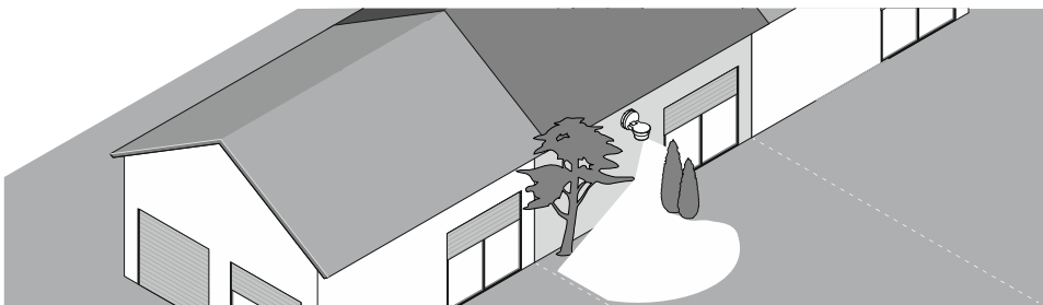
Abb. 23: Wandmontage an Reihenmittelhaus für eingegrenzten Erfassungsradius 6851/9-xxx
